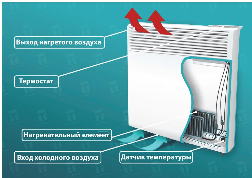
Принцип работы электрического конвектора достаточно прост. Конвектор – прибор, в котором теплопередача происходит за счёт естественного движения воздуха – конвекции: холодный воздух, вступая в контакт с электрическим нагревательным элементом, увеличивает собственную температуру, становится легче и выходит через фронтальную решётку, которая обеспечивает распределение тепла по всему помещению. За счёт циркуляции воздух в пространстве комнаты очень быстро прогревается.
