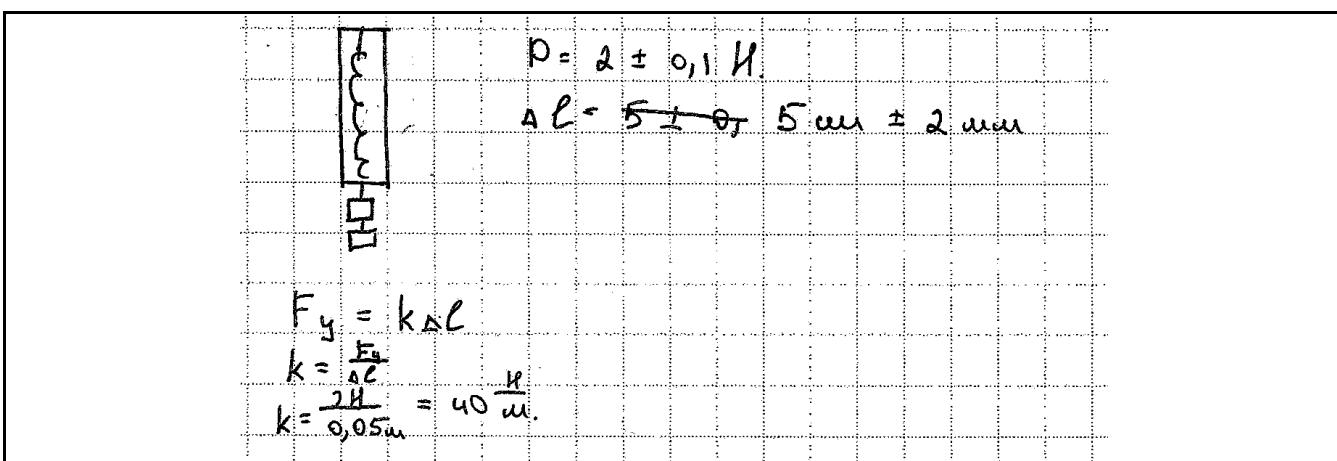
**Комментарий:** на рисунке экспериментальной установки не указано равенство сил упругости и веса тела, соответственно, не обоснован способ измерения жёсткости пружины.
